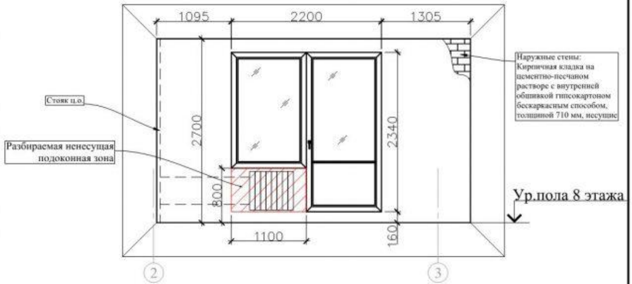
Вид оконного блока до перепланировки
